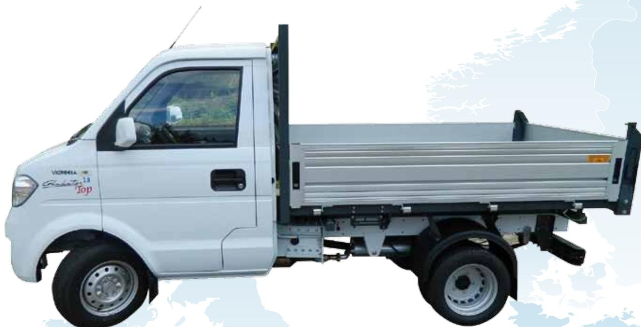
Le stesse caratteristiche tecniche e la stessa motorizzazione del TOP, le ruote gemellate, un passo più corto di 50 cm e una portata che lo rendono il Gladiator più FORTE di sempre. I 17 quintali di portata a telaio permettono di lavorare con un veicolo estremamente maneggevole, con un raggio di sterzata minimo e con una possibilità di carico che lo rendono unico nel suo genere.
